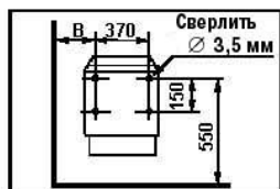
Установка на стене
