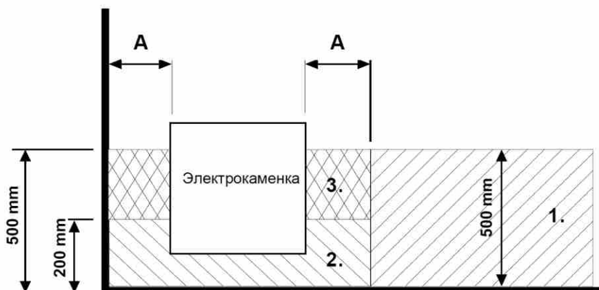
Рис. 3 Установка соединительной коробки
