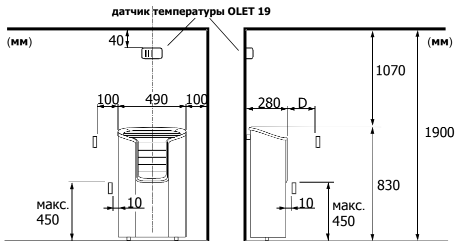
Рисунок 1. Безопасные расстояния для установки электрокаменки
